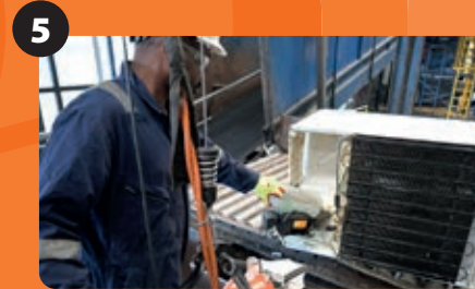
5 Het koelelement wordt met een tang eruit geknipt.
