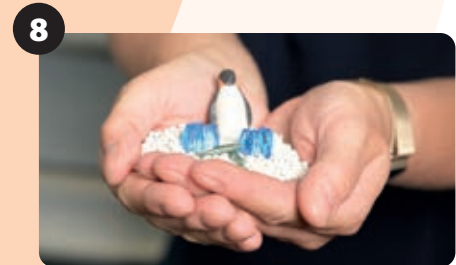
8 Het eindproduct: het granulaat (de plastic korrels) die o.a. worden gebruikt bij de productie van nieuwe koelkasten en Playmobil-poppetjes.
