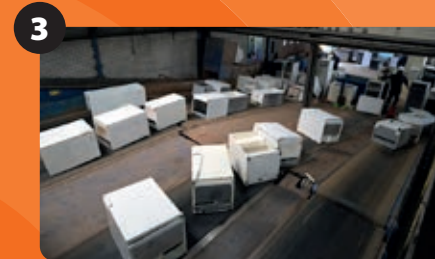
3 De oude apparaten worden handmatig op de lopende band gelegd.
