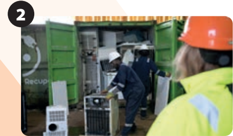
2 De oude apparaten worden allemaal handmatig uit de containers gehaald. Zeer arbeidsintensief.
