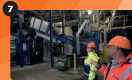
7 De oude apparaten worden verwerkt in de shredder. Metalen en plastic worden van elkaar gescheiden en ook die worden weer gebruikt als grondstof.
